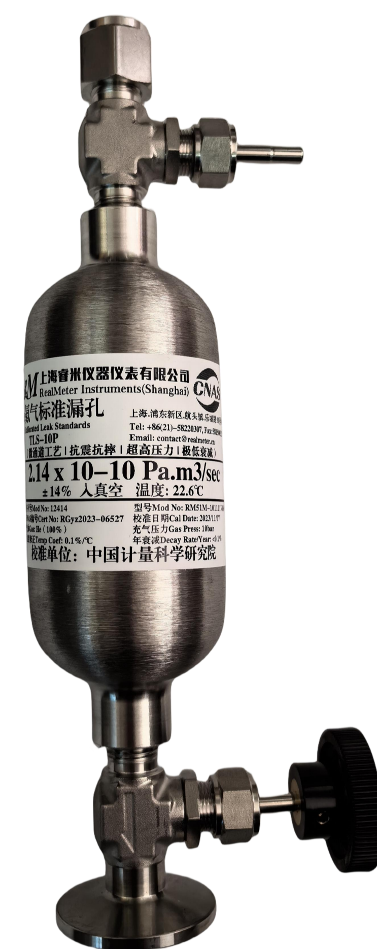
实物照片 RM512.0-101111V0/6 2.14x10 -10 Pa.m 3 /s (10 -9 mbar.L/s) 不确定度: ±10% 110cc气室 10bar, <0.1%/年 KF25, 手动截止阀
