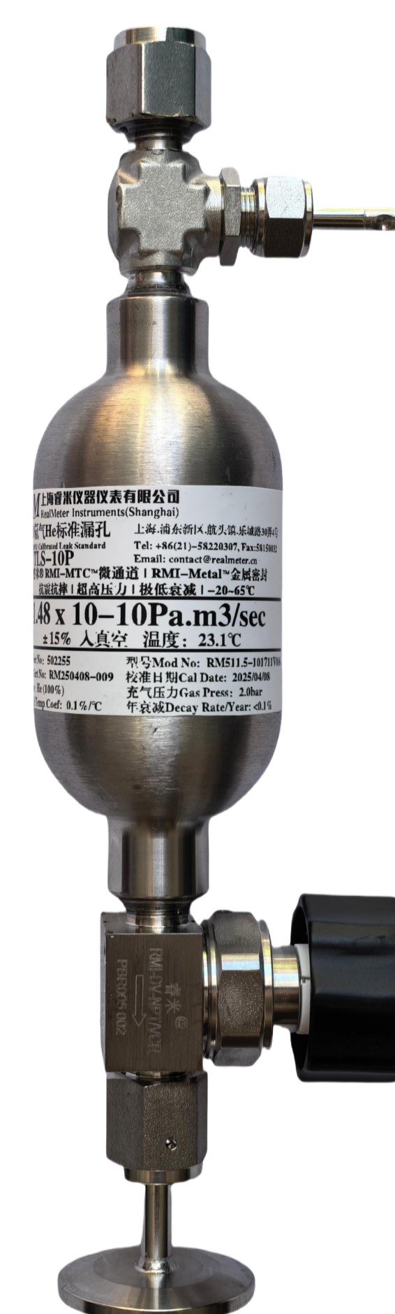
实物照片: RM511.5-101711V0/6 1.48x10 -10 Pa.m 3 /s (10 -9 mbar.L/s) 不确定度: ±10% 110cc气室 2.0bar, <0.1%/年 VCR¼ Male, 手动隔膜阀
