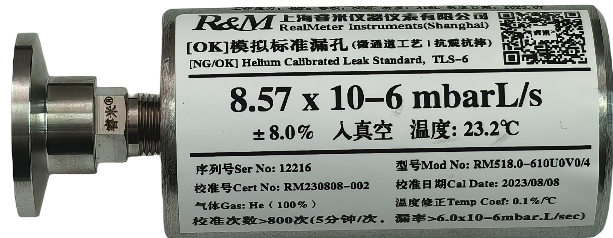
圆柱体电池OK标准漏孔， \phi 38\text{mm} \times 95\text{mm} 要求漏率区间： 6\text{--}9 \times 10^{-6} \text{mbar.L/s}
