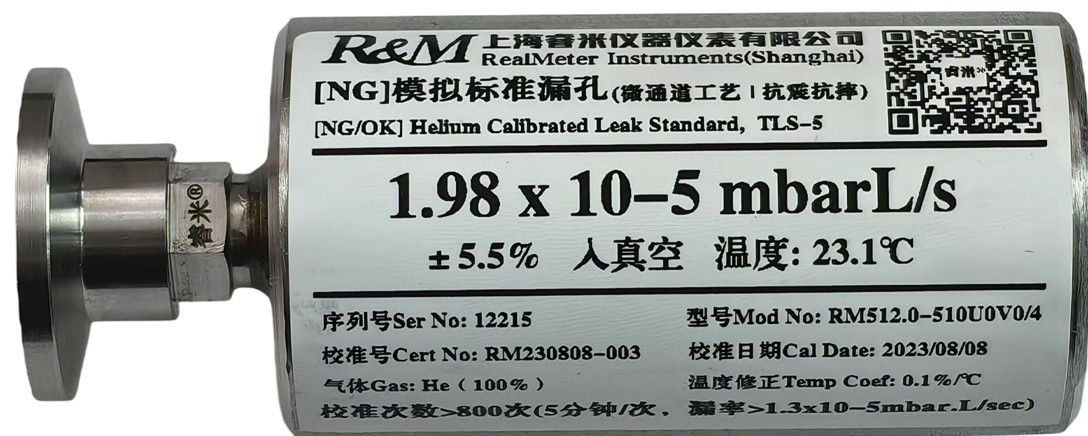
圆柱体电池NG标准漏孔， \phi 38\text{mm} \times 95\text{mm} 要求漏率区间： 1.3\text{--}2.0 \times 10^{-5} \text{mbar.L/s}
