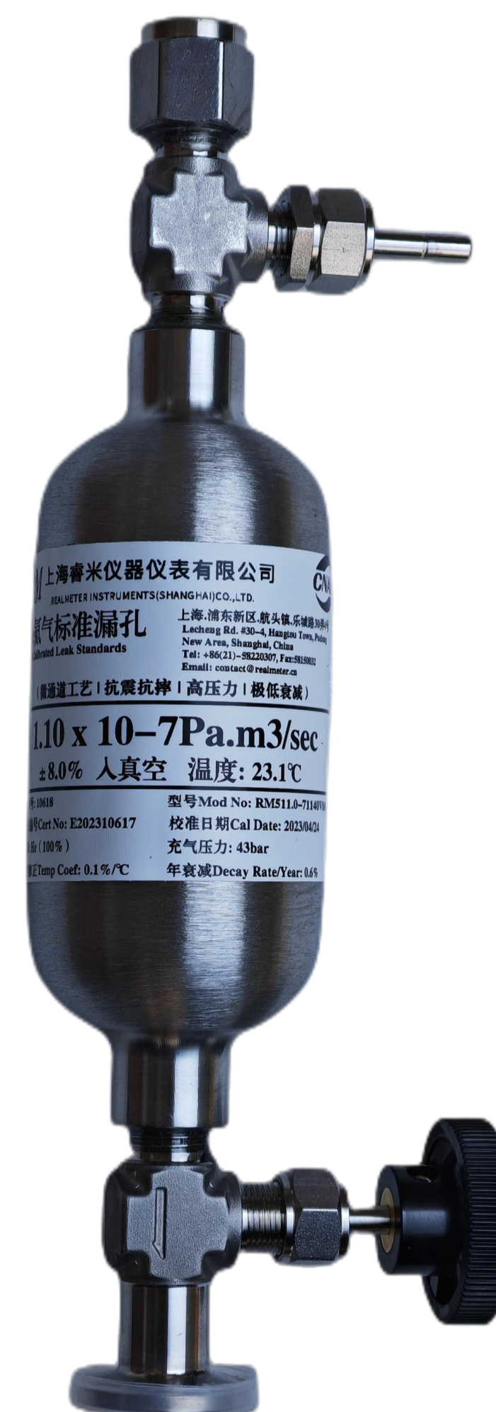
实物照片: RM511.0-71140V0/6 1.10x10 -7 Pa.m 3 /s (10 -6 mbar.L/s) 不确定度: ± 8.0% 160cc气室 43bar, 0.6%/年 KF16, 手动截止阀
