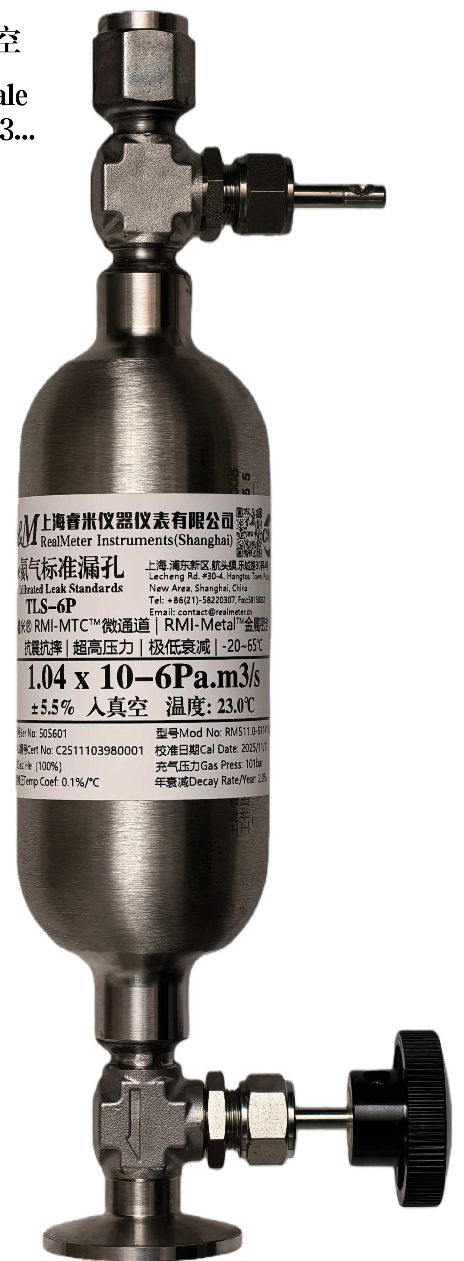
实物照片: RM511.0-61141V0/6 1.04 \times 10^{-6} Pa.m 3 /s ( 10^{-5} mbar.L/s) 160cc气室 121bar, 2.0%/年 KF25, 手动截止阀
